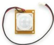
IL **SENSORE PIR** È MONTATO DIETRO UNALENTE FRESNEL. IL SEGNALE DI USCITA DAL SENSORE È AMPLIFICATO E CONDIZIONATO DA DUE ELEMENTI DI UN AMPLIFICATORE OPERAZIONALE, PRIMA DI ESSERE CONNESSO DIRETTAMENTE AD UN CANALE ANALOGICO-DIGITALE (A/D) DEL MICROCONTROLLER (MCU) CHE È IL TRADIZIONALE APPROCCIO ANALOGICO.
