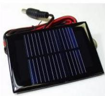
**CELLA SOLARE** DOTATA DI CAVO BIPOLARE E CONNETTORE DA 5.5MM X 2.1MM, POSITIVO CENTRALE, LUNGHEZZA CAVO 2M. QUESTA UNITA' E' ACCREDITATA PER 9.15V E 280MA IN OTTIME CONDIZIONI DI LUCE.
