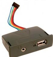
IL **VMUSIC2** È UN DEVICE CHE CONSENTE DI AGGIUNGERE UNA INTERFACCIA USB FLASH DRIVE AD ARDUINO. CONSENTE INOLTRE DI RIPRODURRE FILE MP3 (ED ALTRI FORMATI) DIRETTAMENTE DA UN FLASH DRIVE USB. LE ESTENSIONI DEL SET DI COMANDI PREIMPOSTATI CONSENTONO INOLTRE DI CONTROLLARE IL VOLUME E DI BILANCIARE I CANALI.
